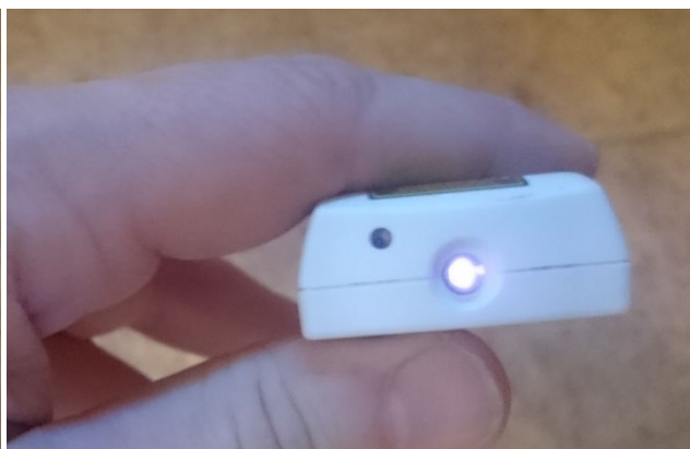
Kamera utan ir-filter registrerar ljus och visar det som synligt ljus på skärmen
